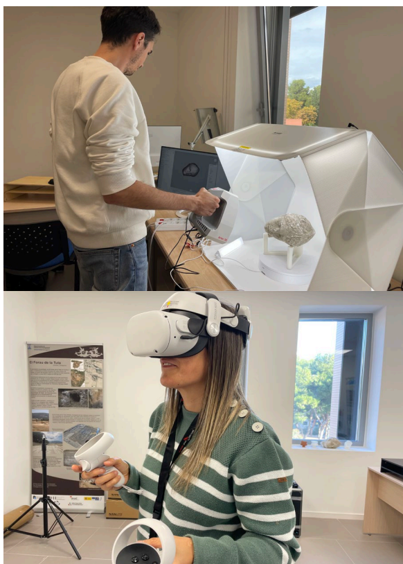
Procesos de digitalización mediante sistemas de escáner 3D de luz estructurada y visualización inmersiva con gafas de realidad virtual en proyectos de investigación del SeGAP.
